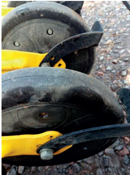
Obr. 16: Secí stroj OMEGA OO 6000 FL umožňuje individuální změnu přítlaku na jednotlivé secí botky (foto Brant).
