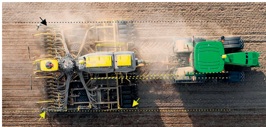
Obr. 17. Secí stroj s dvoukomorovým zásobníkem na osivo a přidavným zásobníkem pro výsev třetí plodiny. Traktor je pomocí automatického řízení veden proti svahu tak, aby s maximální přesností vedl krajovou botku v předchozí jízdě, čímž je dosaženo pravidelného střídání setých plodin a dodržení meziřádkové vzdálenosti (foto Strom Praha).
