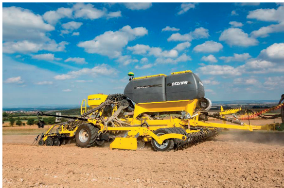
Obr. 15: Secí stroj OMEGA OO 6000 FL osazeným secí jednotkou ALFA DRILL 400 při zakládání porostů máku s pomocnou plodinou jarního ječmene (foto BEDNAR FMT).
